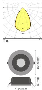
**Technische Daten Ledvance LED Downlight Performance DN195 21W 2520lm 65D - 840 | 220mm - IP54 - Dali Dimmbar**
