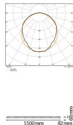
**Technische Daten Ledvance LED Feuchtraumleuchte Feuchtigkeitsdicht 58W 8000lm - 840 | 150cm - Bewegungs- Und Lichtsensor**
