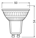
**Technische Daten Osram Parathom LED-Spot GU10 PAR16 4.5W 350lm 36D - 827 | Dimmbar - Ersatz für 50W**
