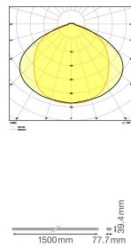
**Technische Daten Ledvance LED Tragschiene Trusys Flex Klar Stahl Weiß 50W 8600lm 120D - 840 Kaltweiß | 3 Stunden Notbeleuchtung**
