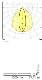
**Technische Daten Ledvance LED Tragschiene Trusys Flex Klar Stahl Weiß 70W 12100lm 30D - 840 Kaltweiß | 3 Stunden Notbeleuchtung**
