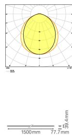
**Technische Daten Ledvance LED Tragschiene Trusys Flex Opal Stahl Weiß 70W 11700lm 90D - 840 Kaltweiß | 3 Stunden Notbeleuchtung**
