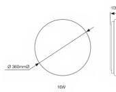
**Technische Daten LED-Wand- und Deckenleuchte Weiß 18W 1561lm - 840 | 360mm - IP44**
