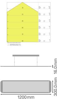
**Caractéristiques Ledvance Dalle LED Direct/Indirect 30x120cm 3000K 36W UGR <19 | Remplacement 2x36W**
