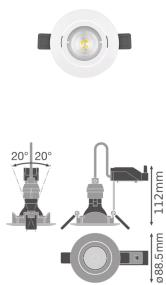
**Caractéristiques Ledvance Spot LED Kit inclinable GU10 PAR16 8.3W 520lm 36D - 930 | Meilleur rendu de couleur - Dimmable - Remplacement 65W**
